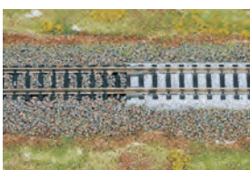
Eine Verbindung mit flexiblen Gleisen ohne Böschung ist möglich
