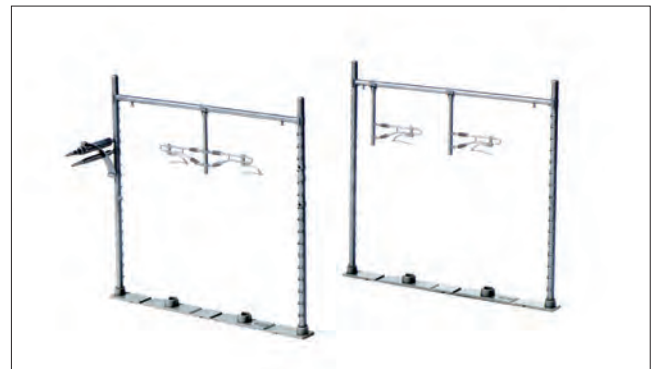
23-067-1 Moderner Betonmast mit Quertragwerk weit 2-gleisig
